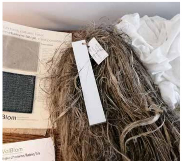
quelques semaines. C'est l'étape du rouissage qui permet de dégrader la cellulose entourant les fibres. Une fois celles-ci extraites de la tige, démêlées, nettoyées et peignées, elles peuvent être transformées en textile.
